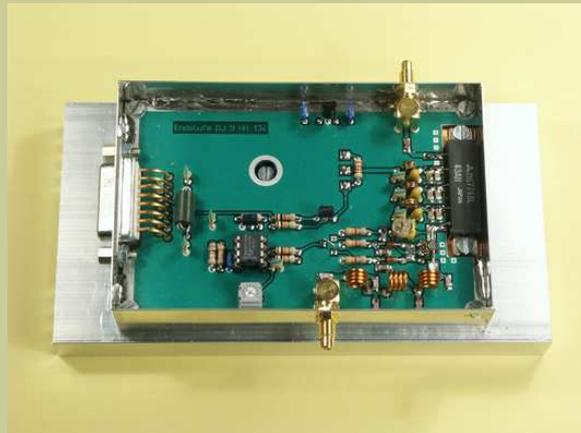
Die Endstufe 145 dient zum Nachverstärken des Signals unserer Synthesizer-Baugruppen, um eine Leistung von 7 Watt zu erzielen. Die erforderliche Ansteuerleistung beträgt 10 - 15 mW bei der 2-m-Version und mind. 15 mW bei der 70-cm-Version. Auf 2m ist eine SWR-Überwachung mit enthalten, bei 70 cm nicht, da die Art der Auskopplung dort so nicht funktionieren würde.
