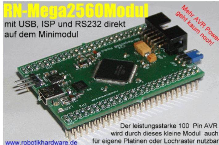
Welche Art von Stiftleisten Sie einlöten, bleibt weitgehend Ihnen überlassen. Empfehlenswert ist es eine 25 Pin Stiftleiste, so wie auf dem Bild zu sehen, einzulöten. Auf einer Experimentierplatine kann dann als Gegenstück eine Buchsenleiste eingelötet werden.
